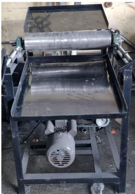
**Gambar 2.** Mesin Penggiling Bahan Baku Hasil Pabrikasi
