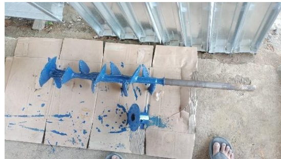
d. Screw pengaduk dan dorongan mendorong campuran keluar melalui ujung pencetak
