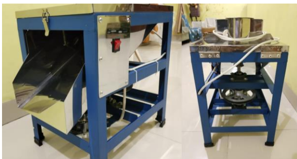
Gambar 2. Tampak Depan Dan Belakang TTG Mesin Pengiris Keripik Yang Ditransfer Kepada Mitra
