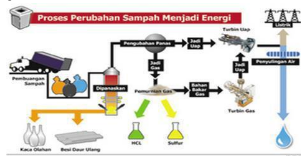
Gambar 2. Proses Kerja PLTSA Thermal Dengan Gasifikasi
