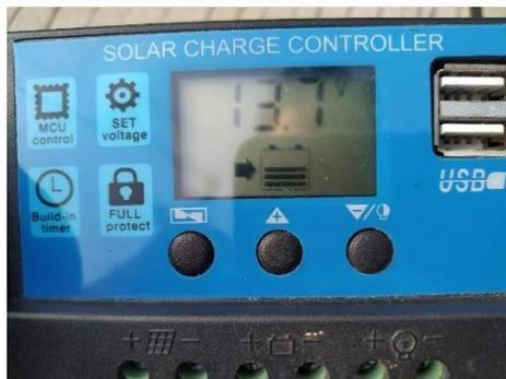
Gambar 6. Tegangan yang masuk ke baterai
