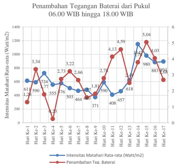
Gambar 3. Karakteristik Penambahan Tegangan Baterai dari Pukul 06.00 WIB hingga 18.00 IB
