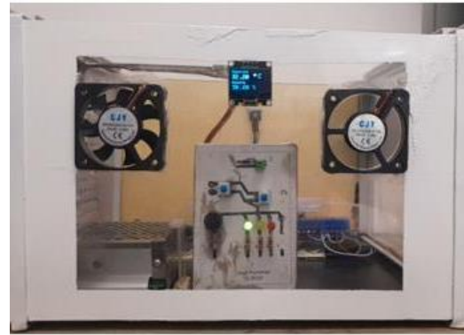
Gambar 3. Rangkaian Alat Monitoring Suhu dan Kelembaban Ruang
