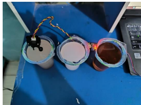
Gambar 18. Proses Pengambilan Data Kekeruhan menggunakan 3 Jenis Air
