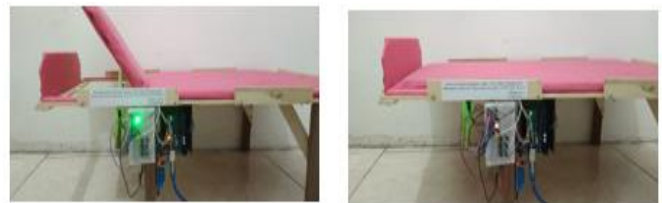
Gambar 2.6 Uji Coba alat pada saat proses pengangkatan dan penurunan posisi kepala tempat tidur pasien
