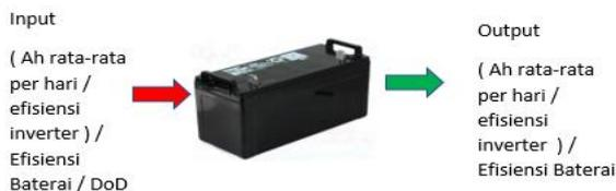
Gambar 4. Rating baterai dengan mempertimbangkan DoD, efisiensi baterai dan inverter
