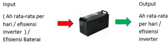
Gambar 2. Rating Ah baterai dengan mempertimbangkan efisiensi baterai dan inverter
