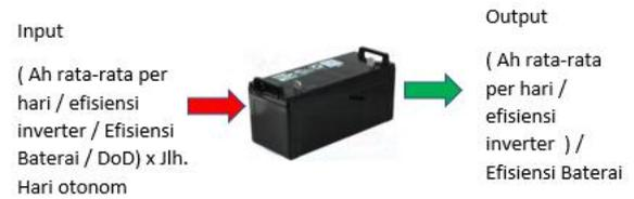
Gambar 5. Kapasitas baterai dengan hari otonom, DoD, efisiensi baterai dan efisiensi inverter
