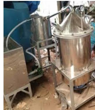
Gambar 2. Alat Destilasi dengan BBM
