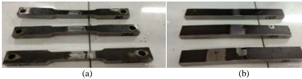
Gambar 2. (a) Spesimen, (b) Uji tarik dan Uji bending
