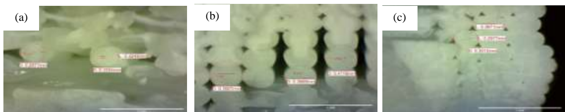
Gambar 14. Hasil Pengujian Makrostruktur pada Perbesaran 220x (a) Gyroid , (b) Concentric , (c) Triangle
