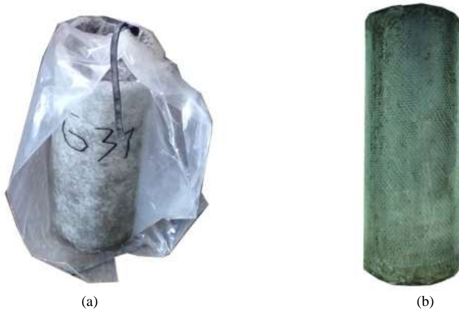
Gambar 1. Proses pemberian selubung serat e-glass pada spesimen uji ASTM C39: (a) Kondisi vakum, dan (b) setelah selubung mengeras
