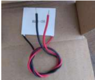
Gambar 1. Bahan Peltier TEC1-12706
