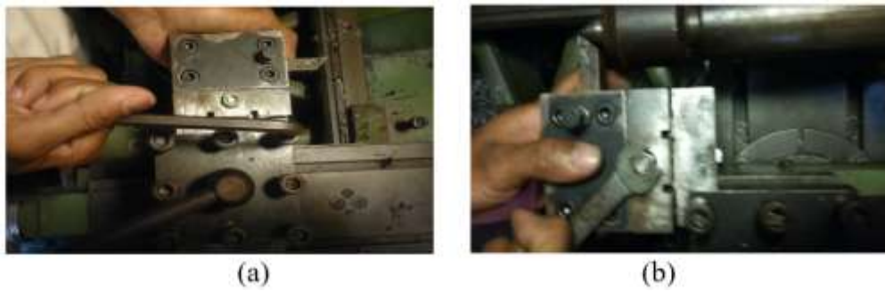
Gambar 4. Pemasangan instrument (a), penyetelan soimetri pada tail stock (b)
