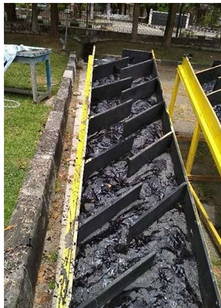
Gambar 4. Kolektor surya dengan menggunakan material absorber (1) pasir besi dan gram besi, (2) pasir besi, (3) aspal hotmix, (4) aspal dan pasir besi
