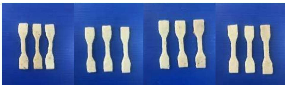
Gambar 1. Penampang Spesimen Tensile Test ASTM D 638 Tipe 4
