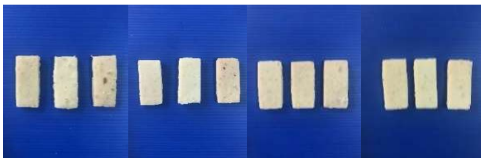
Gambar 1. Penampang Spesimen Tensile Test ASTM D 638 Tipe 4
