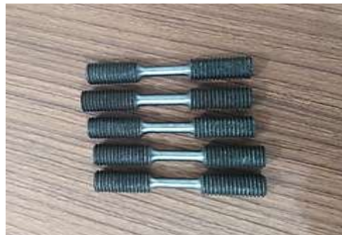
Gambar 2. Spesimen Uji Baja ST 37 setelah di bubut dan di ulir.
