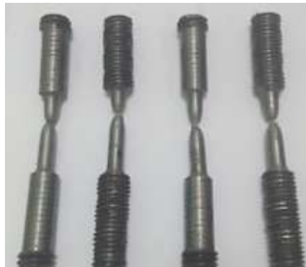
Gambar 4. Hasil spesimen uji Tarik sebelum proses annealing
