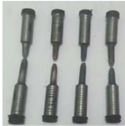
Gambar 5. Hasil spesimen uji tarik sesudah proses annealing
