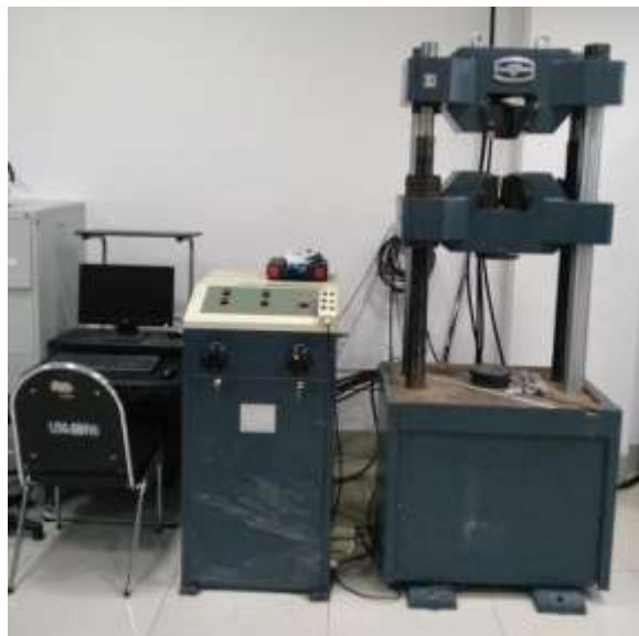
Gambar 1. UTM jenis hidrolik model WEW-300D kapasitas 300 kN
