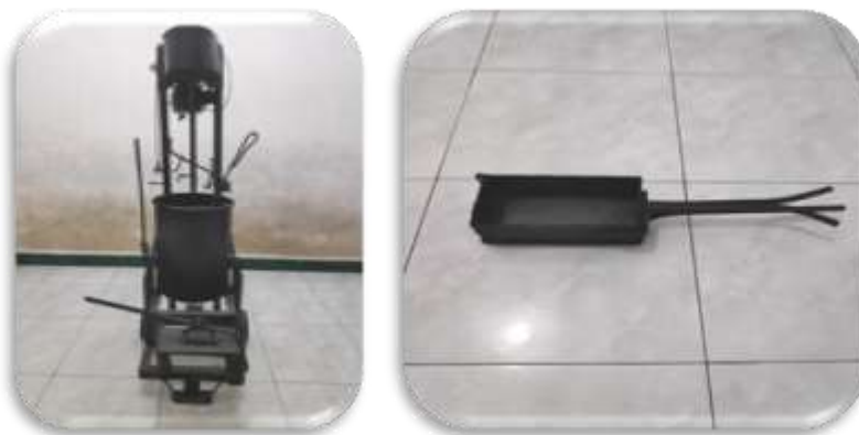
Gambar 2. (a) Alat pembuat paving block , (b) Cetakan, ukuran cetakan paving block ini adalah lebar = 8cm, tinggi = 10cm, dan panjang = 20cm.
