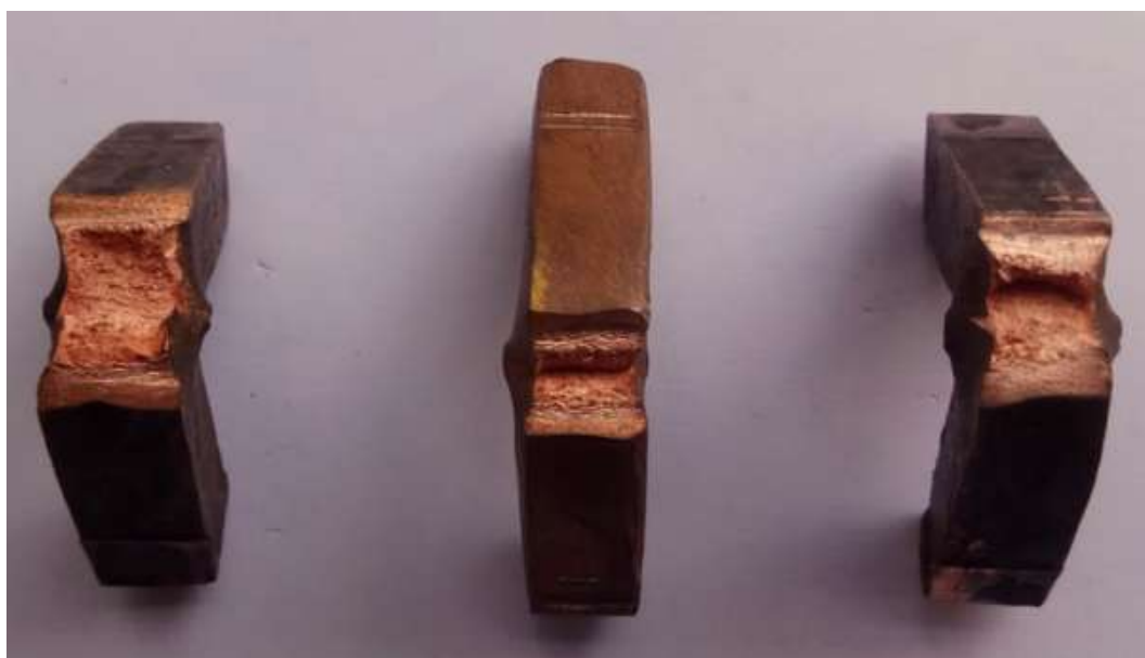
Gambar 9. Bentuk fisik perpatahan bahan tembaga X 2 .
