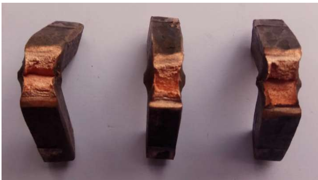
Gambar 8. Bentuk fisik perpatahan bahan tembaga X 1 .
