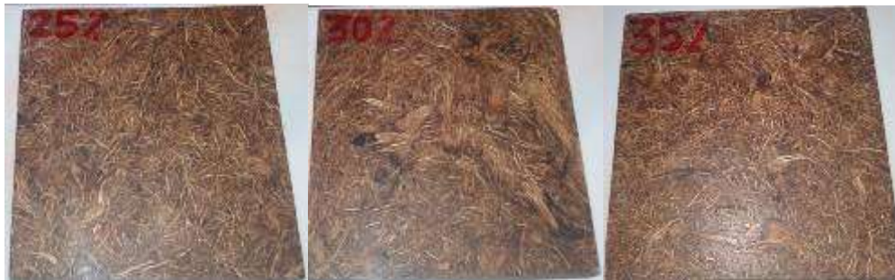
Gambar 2. Papan Partisi Komposit Polimer pengisi Serat TKKS
