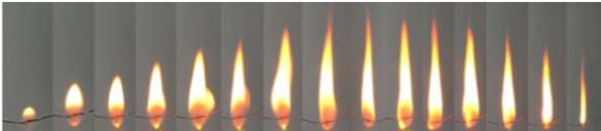
Gambar 5. Evolusi api CKO tanpa bioaditif
