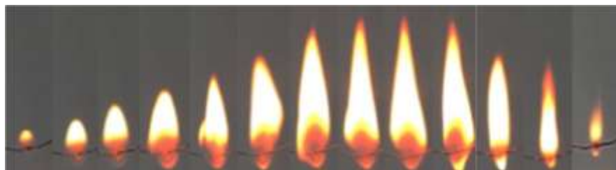
Gambar 7. Evolusi api CKO dengan penambahan 300 ppm aditif
