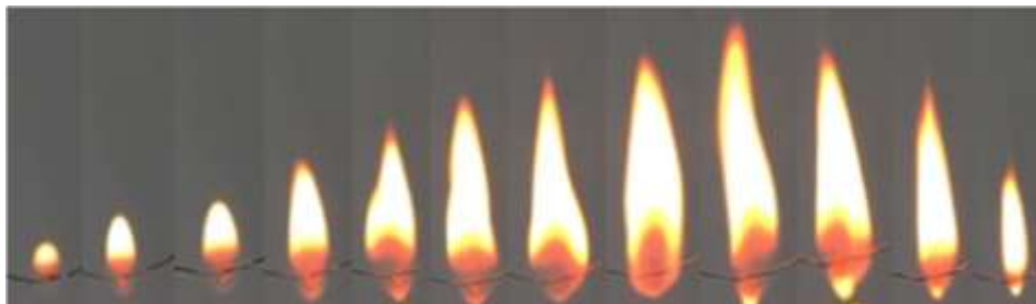
Gambar 6. Evolusi api CKO dengan penambahan 100 ppm bioaditif
