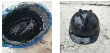
Gambar 6. Hasil Helm yang dibuat dari bahan komposit
