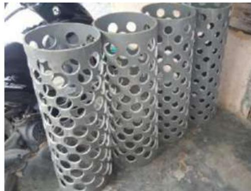
Gambar 4. Hasil perancangan dan pembuatan penyortir (*grader*)
