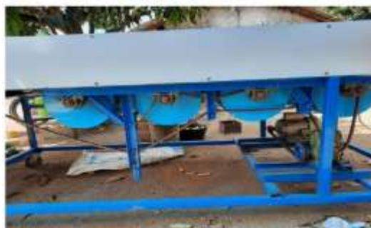
Gambar 7. Rangkaian pemindah daya dari motor listrik – gearbox - grader
