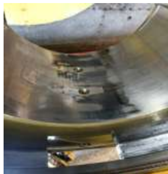
Gambar 5. Lapisan Bantalan Mengalami Gesekan Dan Keausan
