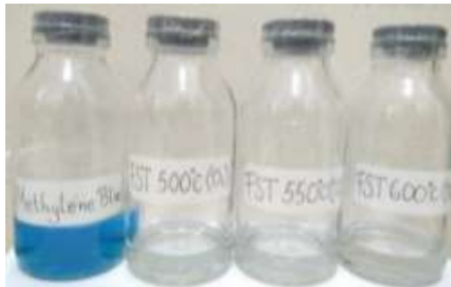
Gambar 5. Fotodegradasi Methylene Blue dengan Katalis \text{Fe}_3\text{O}_4/\text{SiO}_2/\text{TiO}_2
