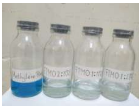
Gambar 5. Fotodegradasi methylene blue dengan katalis Fe 3 O 4 /TiO 2
