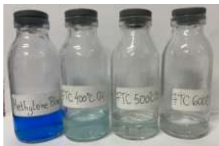
Gambar 5 Fotodegradasi methylene blue dengan katalis \text{Fe}_3\text{O}_4/\text{TiO}_2\text{-Co}
