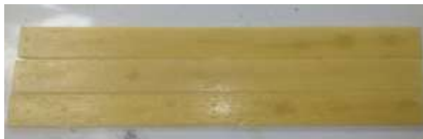
Gambar 5. Material komposit hasil cetakan untuk spesimen uji lentur Sesuai Standar ASTM D 790 - 792.
