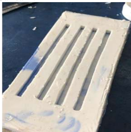
Gambar 4. Bentuk cetakan spesimen uji lentur menurut Standar ASTM D 790 - 792.
