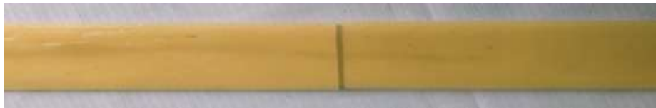
Gambar 7. Bentuk material komposit setelah pengujian lentur material komposit.
