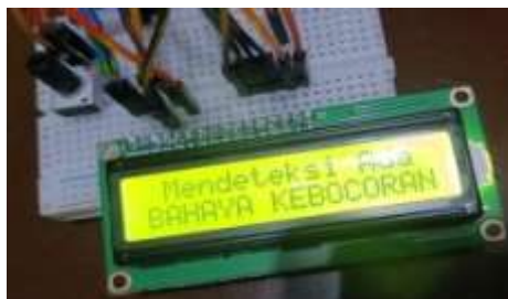
Gambar 12. Display dari layar LCD mendeteksi adanya kebocoran
