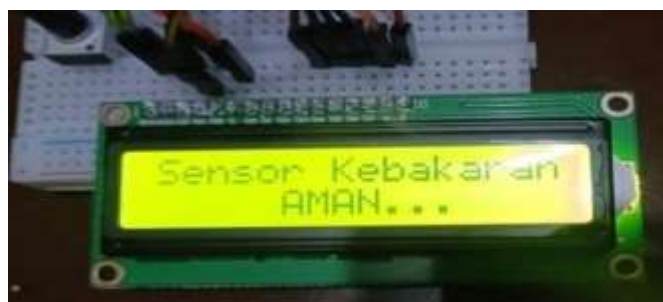
Gambar 11. Display dari layar LCD menunjukkan tidak adanya kebocoran
