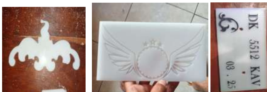
Gambar 11. Hasil pengujian dengan software desain dan G-Code Aspire
