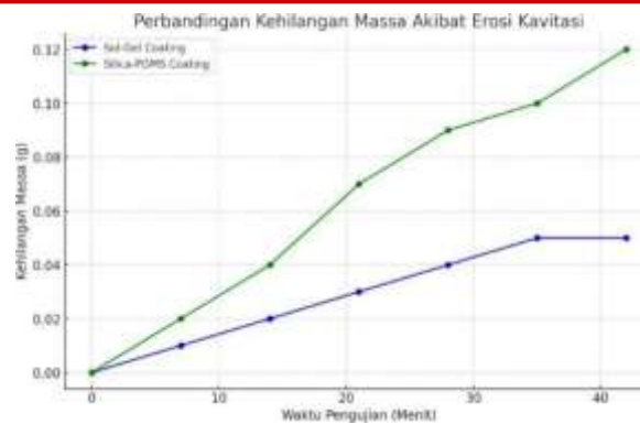
Gambar 4. Grafik Perbandingan Kehilangan Massa Akibat Erosi Kavitasi dari Coating Sol-Gel dan Silika-PDMS
