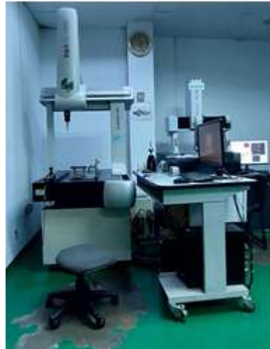
Gambar 2. Melsin CMM 4D untuk Pelngukuran Dimensi
