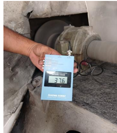
Gambar 6. Vibrasi pada posisi aksial bearing bagian dalam
