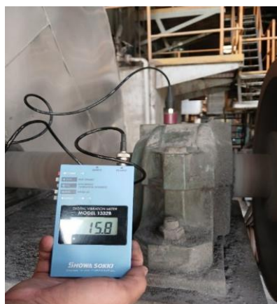
Gambar 7. Vibrasi pada posisi vertikal bearing bagian luar
