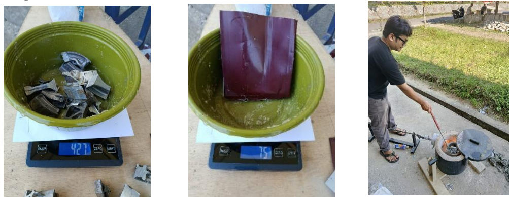
Gambar 2. Proses penimbangan komposisi material yang akan dileburkan
