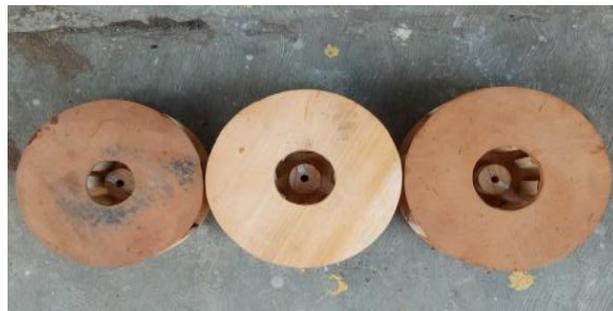
Gambar 2. Impeller blower sentrifugal
