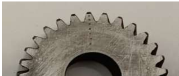
Gambar 7. Pengujian kekerasan pada specimen
