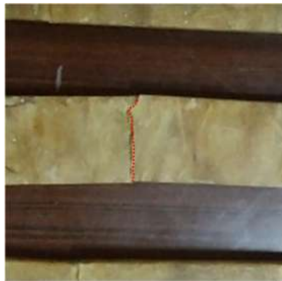
Gambar 4. Bentuk patahan tipikal spesimen uji tarik
