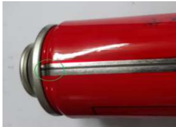
Gambar 7. Pengecekan kebocoran cone.
