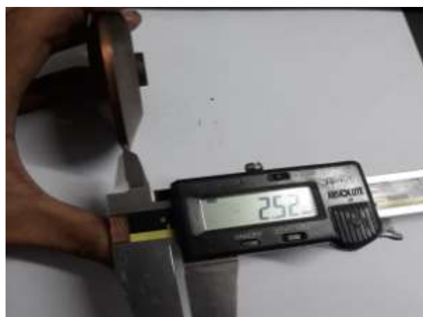
Gambar 12. Pengukuran lebar upper dan lower welding roll
