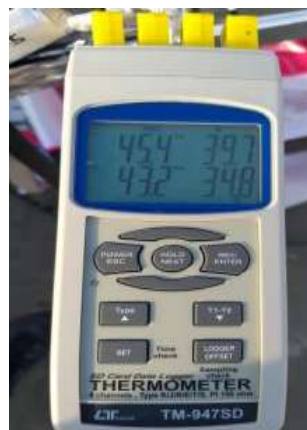
Gambar 2. Alat ukur temperatur 4 titik sekaligus merekam data
