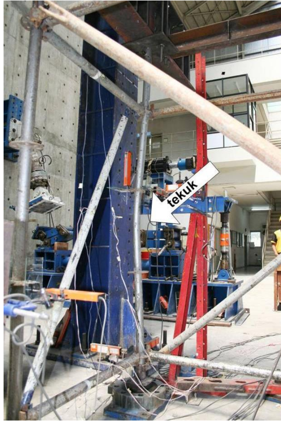
Gambar 37: Bentuk kerusakan scaffolding uji (Dewobroto, 2013a).
