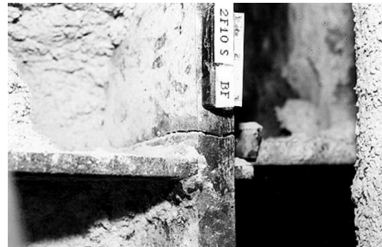
(b). Fraktur pada pelat sayap kolom
