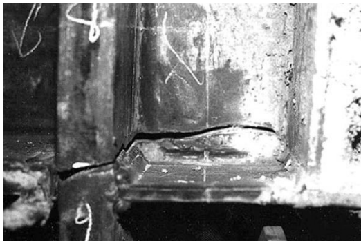
(a). Fraktur yang merambat sampai pelat di zona panel
