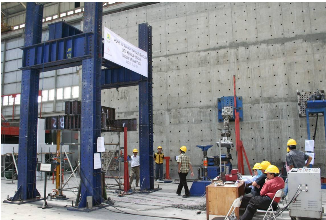
Gambar 36: Situasi pengujian scaffolding (Dewobroto, 2013a)
