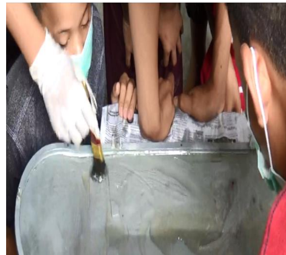
Gambar 3.5 Pelapisan resin pada permukaan cetakan
