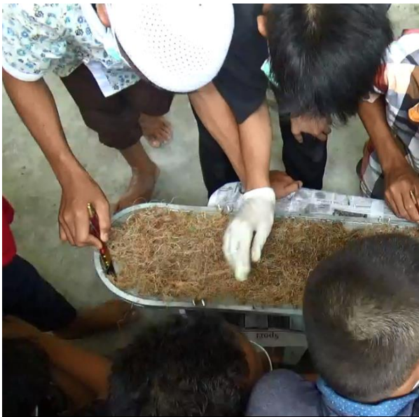
Gambar 3.6 Pelapisan serat sawit pada lapisan resin
