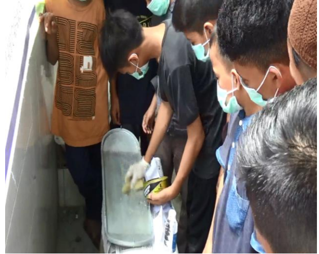
Gambar 3.4 Pelapisan cetakan dengan mould release glaze wax
