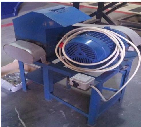
Gambar 1. Mesin pencacah botol plastik
